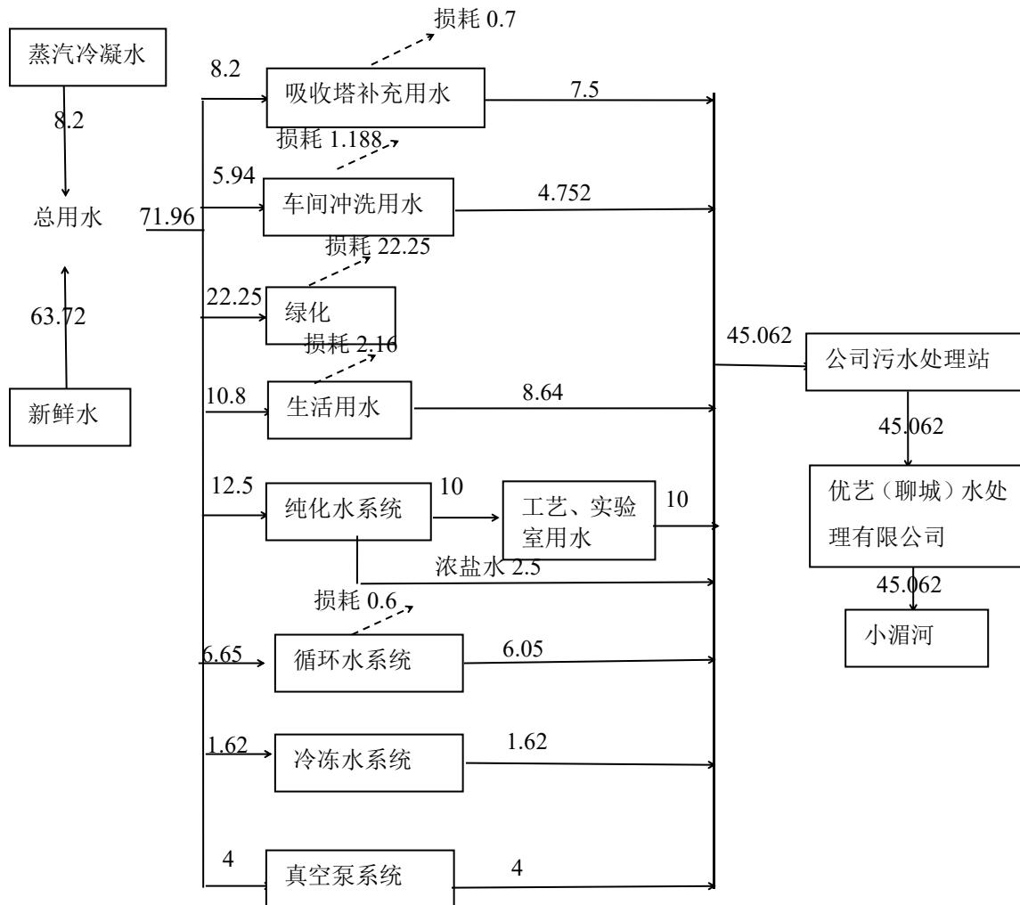
图 3.4-1 项目水平衡图 ( $\text{m}^3/\text{d}$ )
