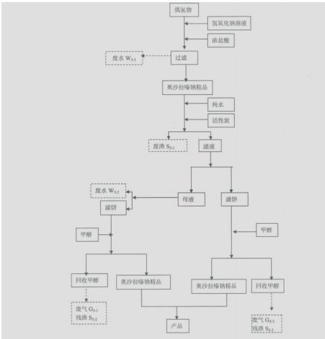
图 3.5-3 奥沙拉嗪钠原料药生产工艺流程图
