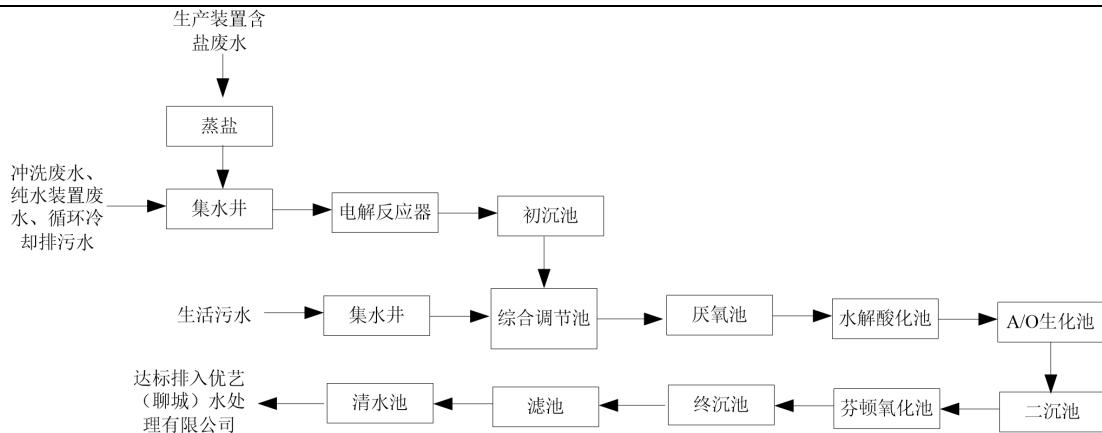
图 3.4-2 污水处理站污水处理工艺流程图
